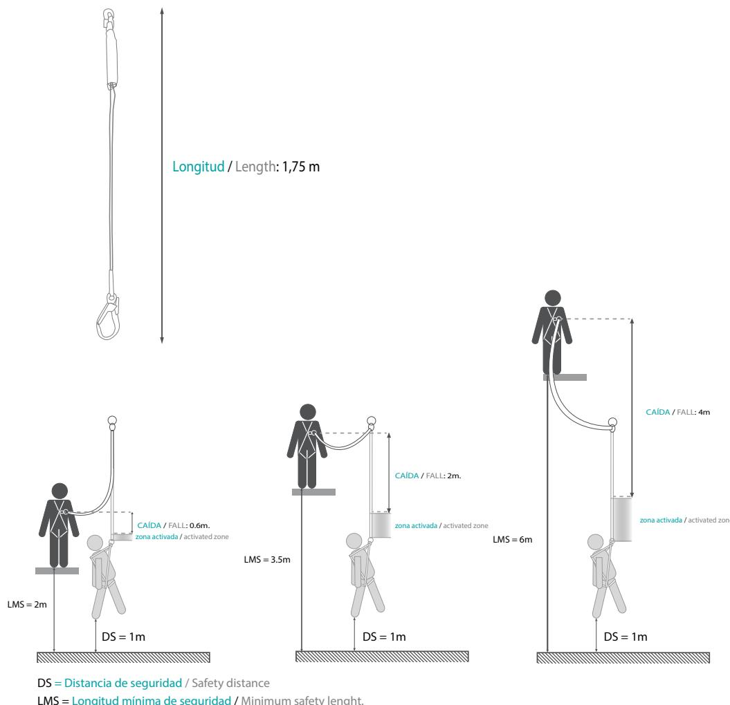
La longitud máxima admisible del absorbedor de energía incluido el absorbedor de energía y los conectores no debe exceder de los dos metros
